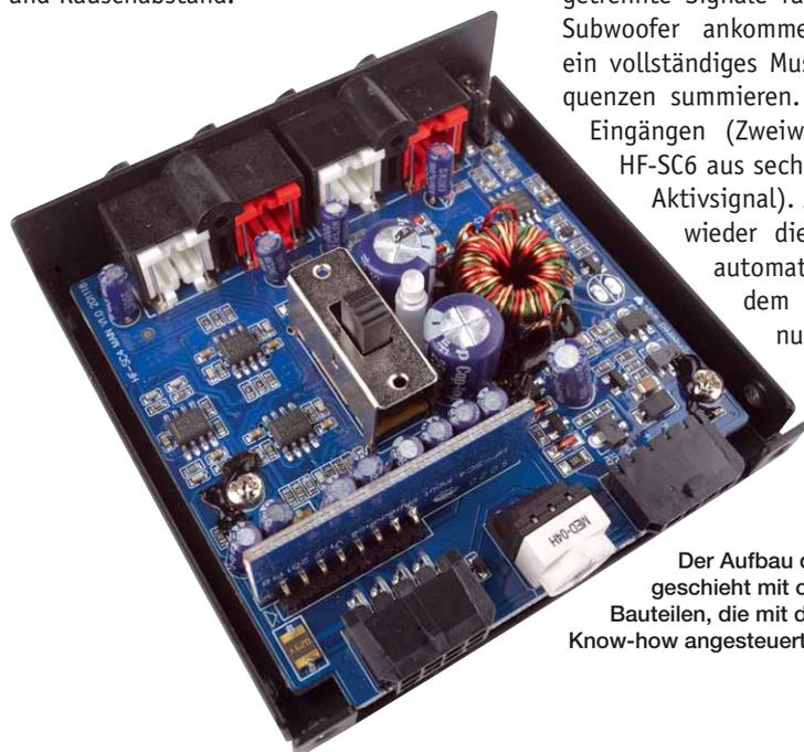
Der Aufbau der HF-SCs geschieht mit ordentlichen Bauteilen, die mit dem richtigen Know-how angesteuert werden
